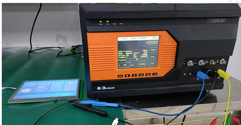
3.2 群脉冲测试图 EFT test
