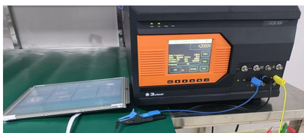
3.2 群脉冲测试图 EFT test
