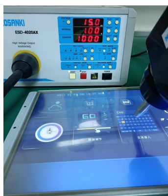
3.1 静电放电测试图 Electrostatic discharge test
