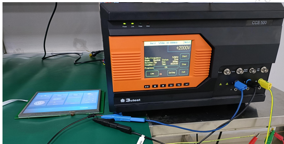
3.2 群脉冲测试图 EFT test
