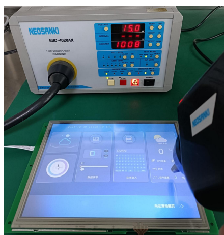
3.1 静电放电测试图 Electrostatic discharge test
