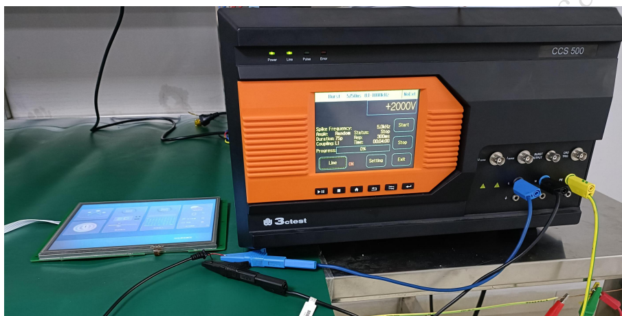
3.2 群脉冲测试图 EFT test
