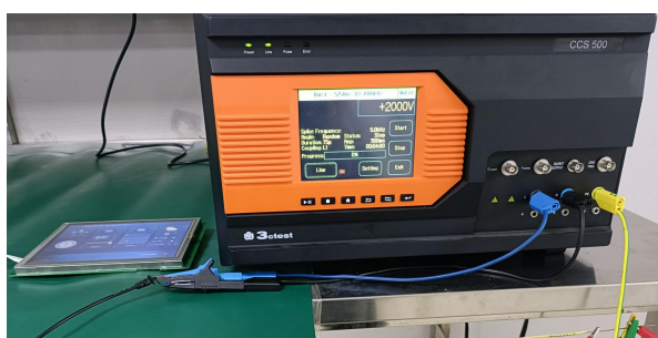
3.2 群脉冲测试图 EFT test
