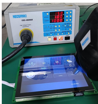
3.1 静电放电测试图 Electrostatic discharge test
