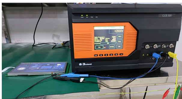
3.2 群脉冲测试图 EFT test
