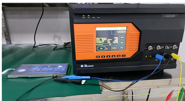
3.2 群脉冲测试图 EFT test
