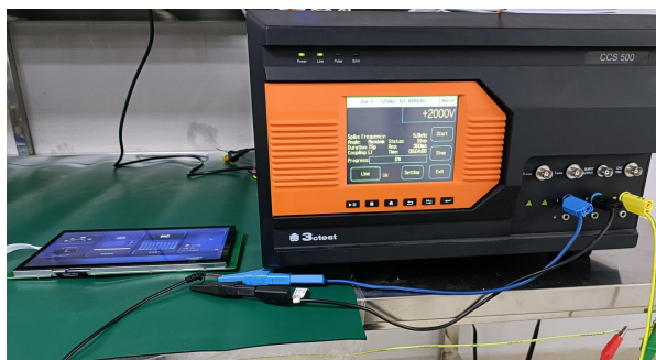
3.2 群脉冲测试图 EFT test
