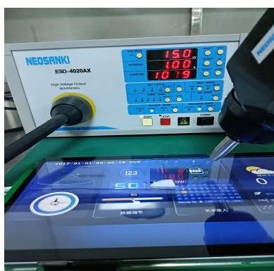
3.1 静电放电测试图 Electrostatic discharge test
