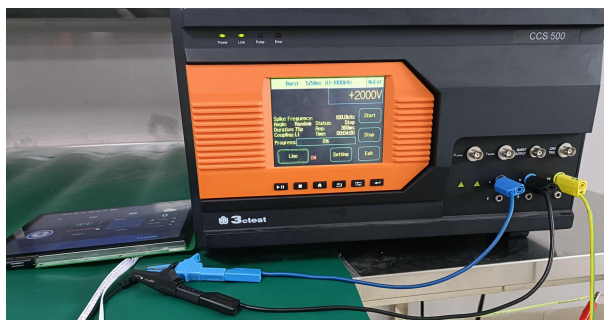
3.2 群脉冲测试图 EFT test
