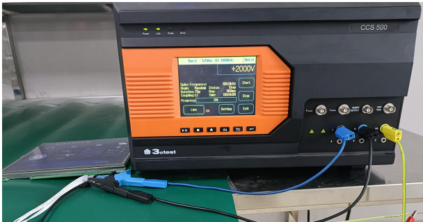
3.2 群脉冲测试图 EFT test
