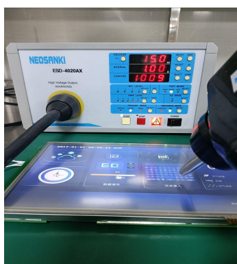
3.1 静电放电测试图 Electrostatic discharge test
