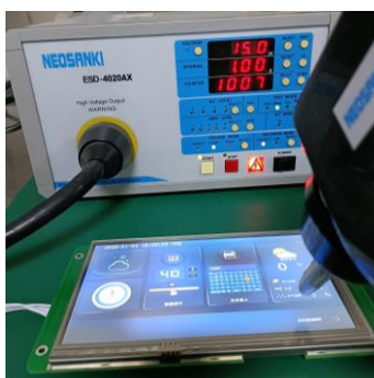
3.1 静电放电测试图 Electrostatic discharge test
