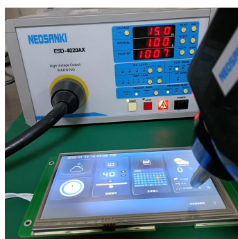
3.1 静电放电测试图 Electrostatic discharge test
