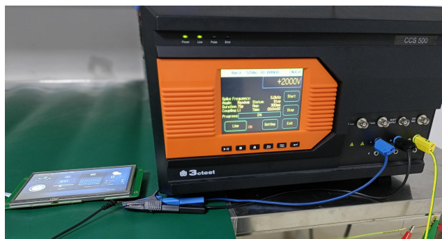
3.2 群脉冲测试图 EFT test
