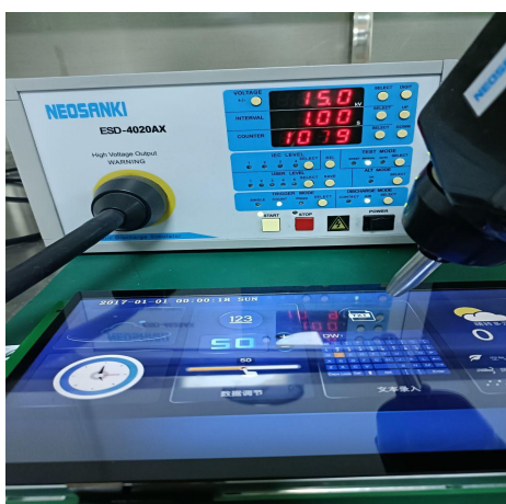
3.1 静电放电测试图 Electrostatic discharge test
