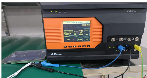
3.2 群脉冲测试图 EFT test
