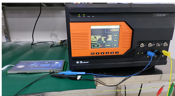
3.2 群脉冲测试图 EFT test
