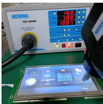
3.1 静电放电测试图 Electrostatic discharge test
