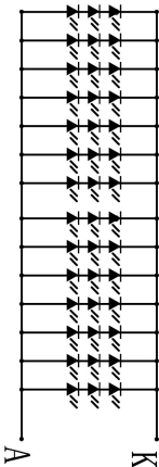
电路图: 3串14并=42LED
