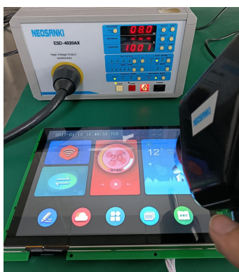
3.1 静电放电测试图 Electrostatic discharge test
