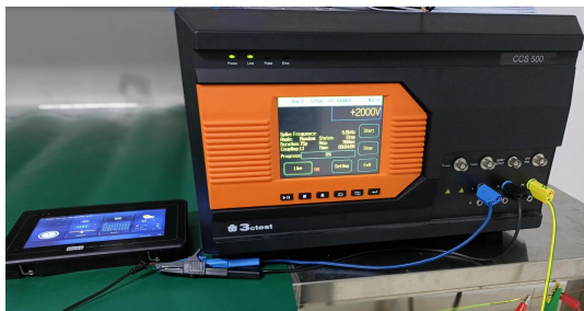
3.2 群脉冲测试图 EFT test
