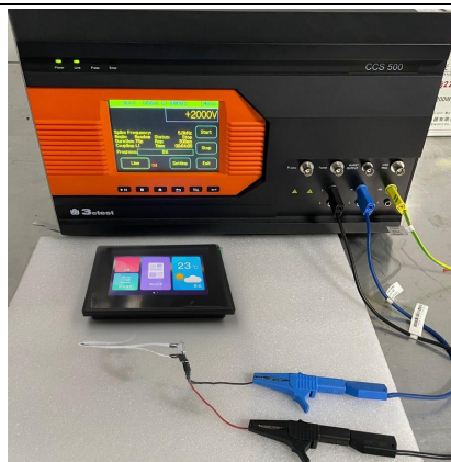
3.2 群脉冲测试图 EFT test
