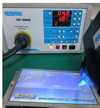
3.1 静电放电测试图 Electrostatic discharge test
