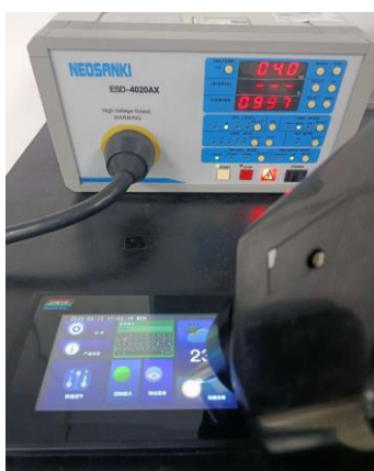
3.1 静电放电测试图 Electrostatic discharge test
