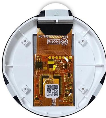
屏幕外壳背面分别有3个卡扣；屏幕外壳中间位置标注“△”，指示屏幕安装方向。
