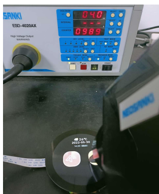
3.1 静电放电测试图 Electrostatic discharge test
