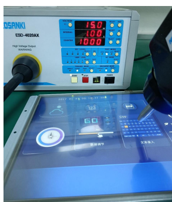
3.1 静电放电测试图 Electrostatic discharge test
