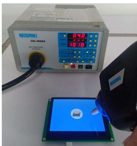
3.1 静电放电测试图 Electrostatic discharge test
