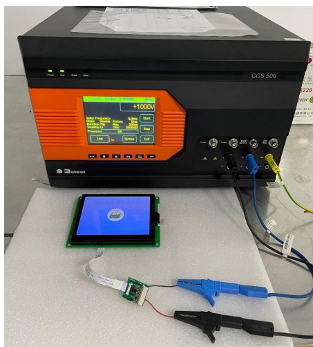
3.2 群脉冲测试图 EFT test
